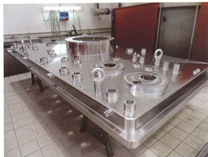
Il basamento di un monoblocco in fase di preparazione.
