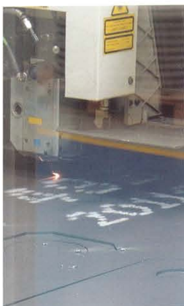
Particolare del taglio laser della lastra in acciaio.
