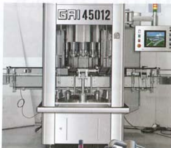
LE MONOBLOC 45012 teste les bouteilles avant la mise et élimine les défectueuses.
